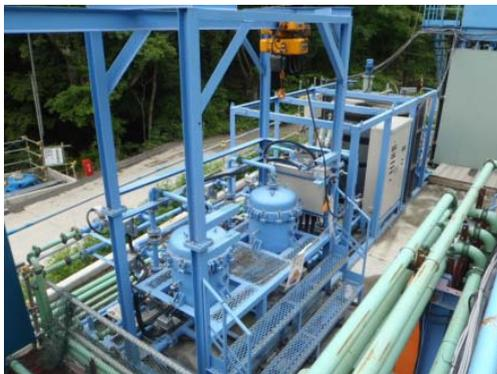
醍醐山トンネルで採用した濁水処理システム
